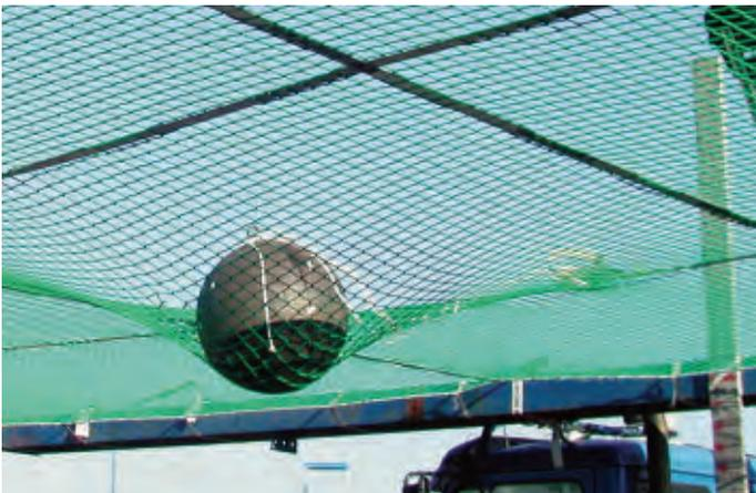
Test de chute d'une masse sphérique de 100 kg.
