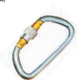
Réf. 2016 Mousqueton de sécurité en acier galvanisé, 120 x 11 mm, C-DIN 5299, charge de rupture 18 kN, (charge de travail 4,5 kN)
