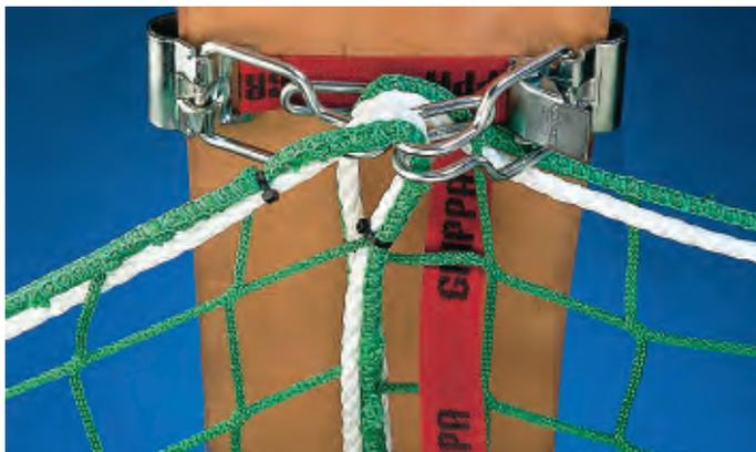
Le système «Grippa» est constitué de deux pinces crochets qui, mises en place sur les deux côtés de l'aile de la poutrelle, sont maintenues par serrage de la sangle et sécurisées par une boucle de fermeture.
