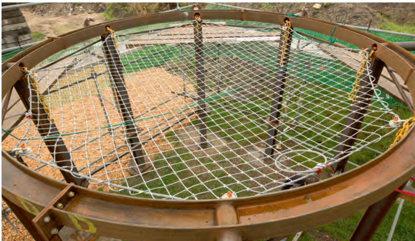
Filet en câble acier « Dralo Xtreme » monté sur structure porteuse circulaire
