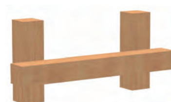
Transversale montée devant les montants*
