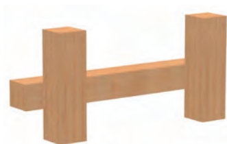
Transversale montée derrière les montants (recommandé)*
