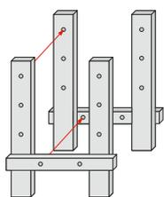
Transversale derrière les montants (recommandé)
