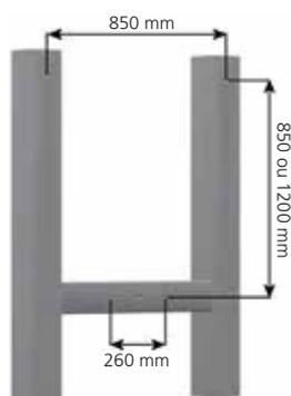
Schéma type pour un pont en U avec passerelle
