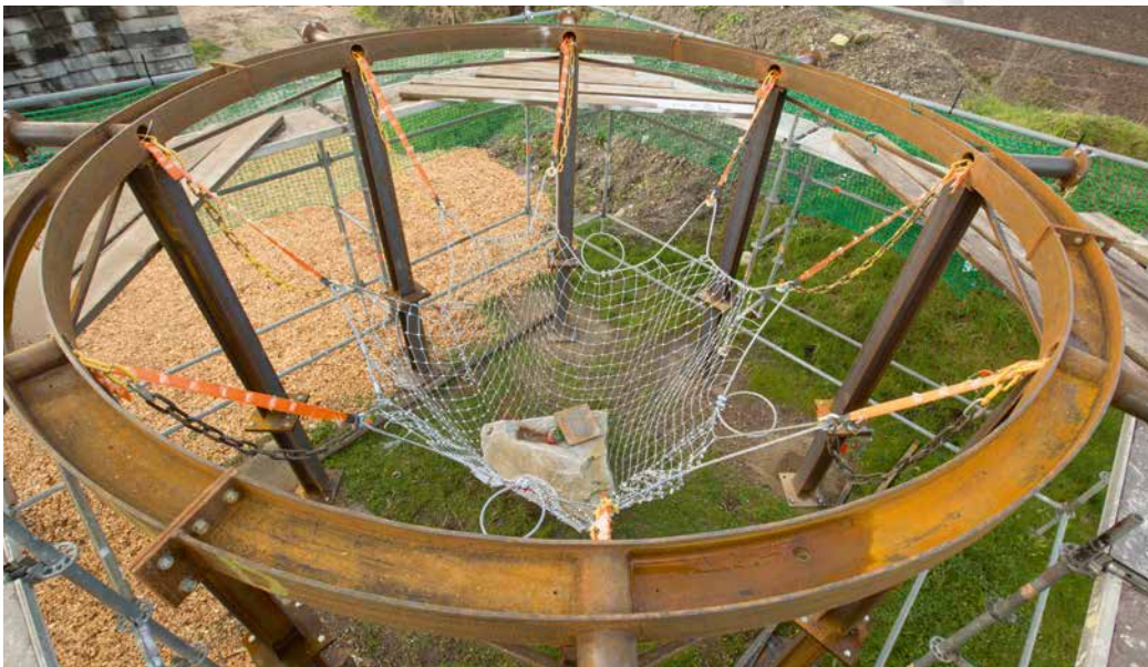
Etat du filet après essai, avec sangles éprouvées La masse test était un rocher brut de forme irrégulière. Poids : 685 kg . Hauteur de chute : 7,50 m.
