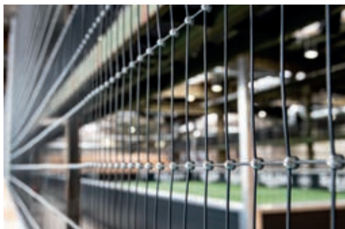
Filet anti-vandalisme en câble acier plastifié ø 1.8/2.5 mm, maille 50 x 100 mm
