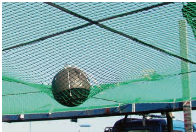
Test de chute d'une masse sphérique de 100 kg.
