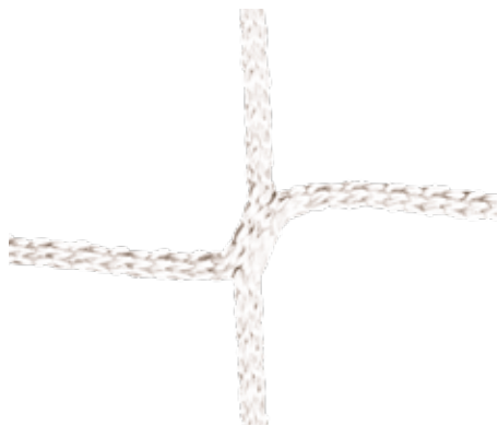
n° 209 blanc, sans nœuds Polypropylène haute résistance, ø 3 mm
