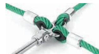
Manille à œil triple M10, Inox Réf. 440-20 Idéal pour la fixation des filets horizontaux dans les angles. Pour raccorder 3 câbles Hercule Ø 16 mm ou 18 mm à une chaîne 6 mm ou 8 mm, ou à un connecteur.
