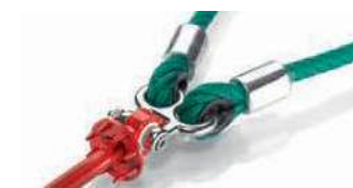
Manille à œil double M10, Inox Réf. 440-10 Sans la bague rouge. Idéal pour la fixation des filets horizontaux dans les angles. Pour raccorder 2 câbles Hercule Ø 16 mm ou 18 mm à une chaîne 6 mm ou 8 mm, ou à un connecteur.
